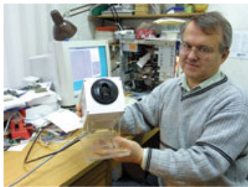
Wiesław Bicz z firmy Optel i jego ultradźwiękowa holograficzna kamera do rozpoznawania odcisków palców
